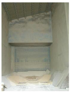
圖 2-20、散裝原料的卸載口周圍,常會堆積粉塵與破碎的原料, 要定期清除,以防受潮而發霉。
