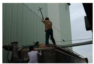
圖 2-59、尚未卸飼料入圓筒倉前由散裝車車頂以大採樣棒進行採樣。
