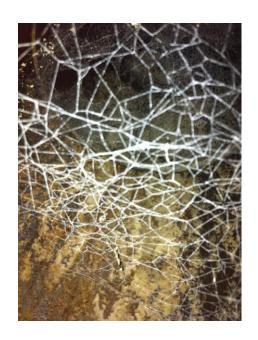
圖 2-24、輸送玉米之管線內部易有蜘蛛網並沾附玉米碎屑。
