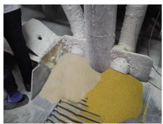
圖 2-54、自配戶混合機原料入料口及其上之管線沾滿粉塵。
