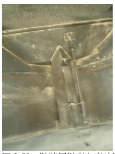
圖 2-50、散裝飼料車之車斗底部粉塵附著例。
