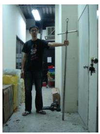
圖 2-58、散裝車採樣用之採樣棒。
