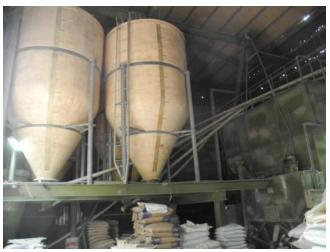
圖 2-55、自配戶的大宗原料散裝筒與管線。
