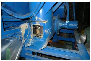
圖 2-61、散裝車車後的採樣口。
