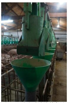
圖 2-84、應定時清除積存於下料的管線與承接口內壁處之飼料以避免 發霉。
