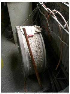
圖 2-37、未將輪模上模孔內的粒料清乾淨且粒料水分含量高而致使發霉。
