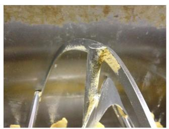
圖 2-32、攪拌葉片角落與混合機內壁遭受粉料附著。
