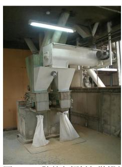
圖 2-44、散落在飼料包裝機外地上之飼料應掃除, 若置之不理任其發霉將成為廠房內散佈黴菌孢子之溫床。
