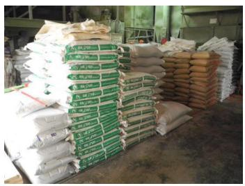
圖 2-57、自配戶小宗原料堆疊情形:缺失為常未用棧板,僅以一塊薄 木板墊底,使底部的飼料易受潮,而產生黴變。
