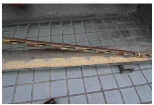
圖 2-60、採樣後在承載槽內旋開採樣棒之內壁以倒出所採集之飼料樣品。
