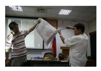
圖 2-73、小採樣棒溝槽朝上,針對飼料袋的四個角落分別插入取樣。
