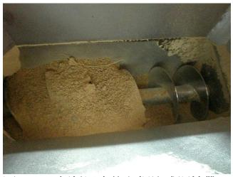
圖 2-34、飼料混合後之螺旋式運輸帶。
