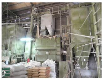
圖 2-52、自配戶橫臥式飼料混合機總覽:其機具、管線沾滿粉塵。
