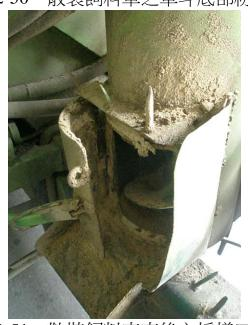
圖 2-51、散裝飼料車車後之採樣口、蓋子、管壁與螺旋輸送軸上 所附著的飼料已黴變結塊。
