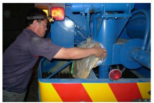
圖 2-62、由散裝車後的採樣口於卸運飼料時進行採樣。
