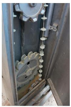
圖 2-80、自動餵飼系統的飼料輸送管線之拖鍊應定時 予以清除積存之飼料以避免發霉。
