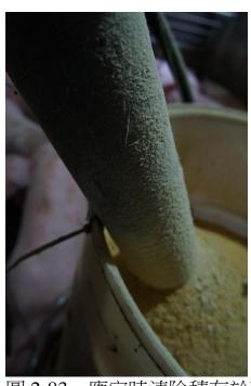
圖 2-83、應定時清除積存於下料的管線外壁與飼料槽內壁、 底盤處之飼料以避免發霉。
